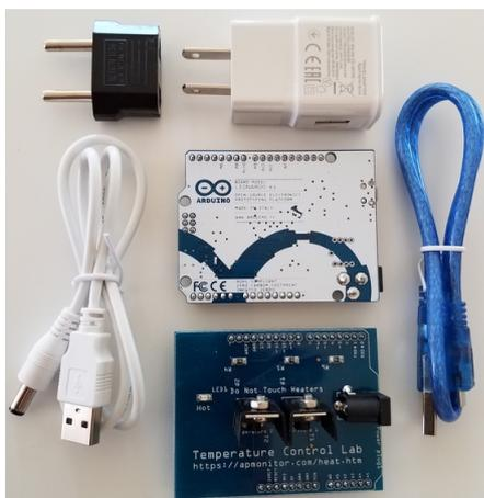
Figura 1: Componentes do TCLab [1].
